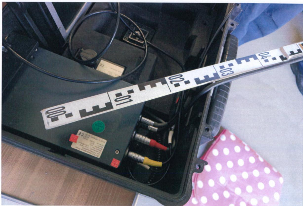
Bild 52: Kabellänge kleiner 4 m
