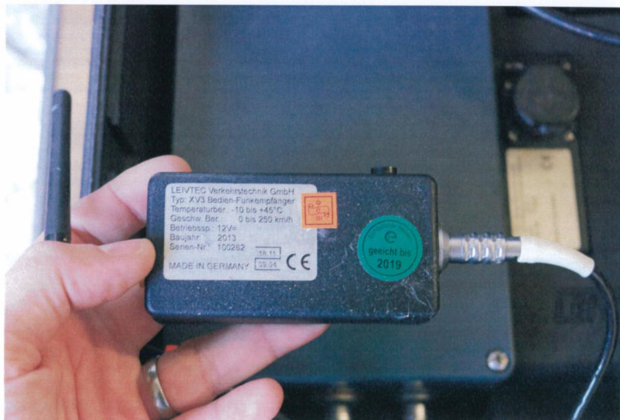
Bild 38: Bedien-Funkempfänger
