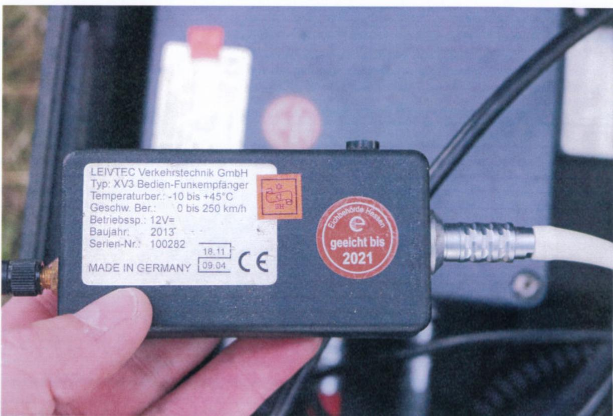
Bild 29: Bedien-Funkempfänger
